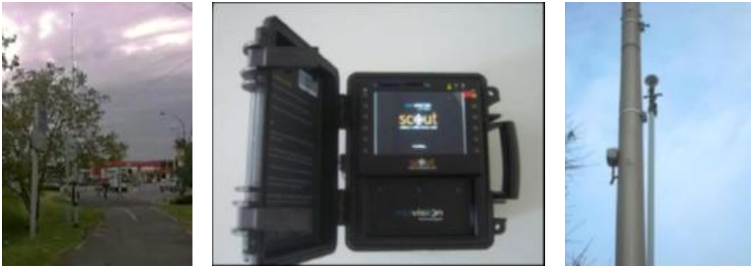
Figure 138 : Mât de comptage avec caméra et boîtier d’enregistrement
