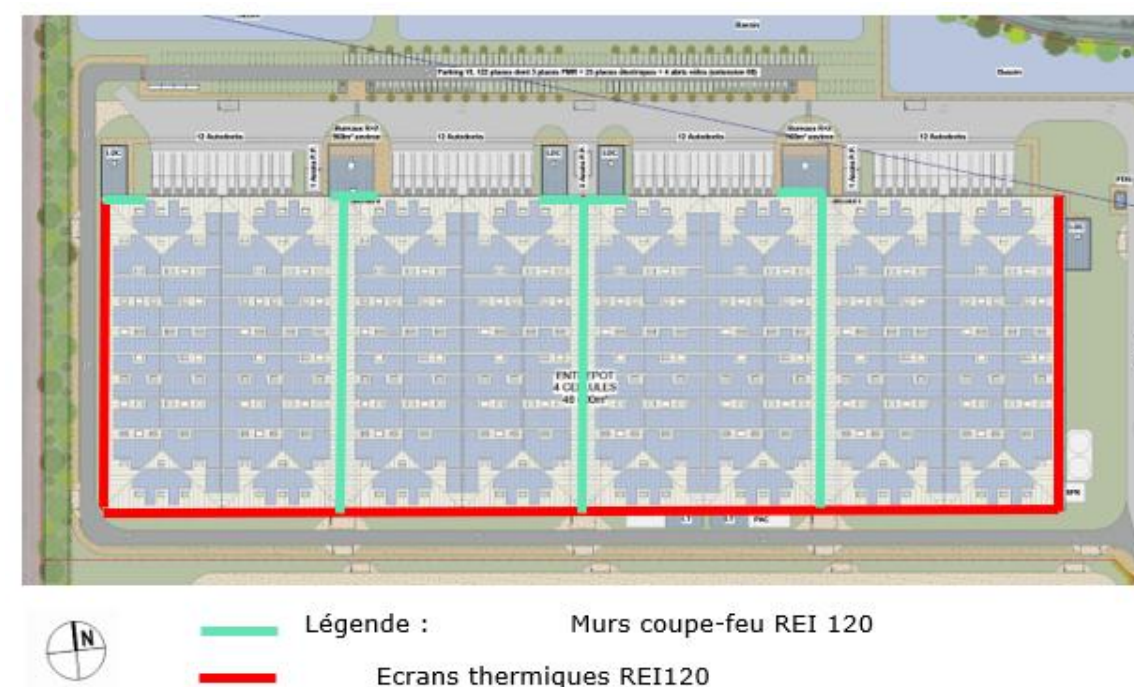
Figure 18 : Structure du bâtiment 4
