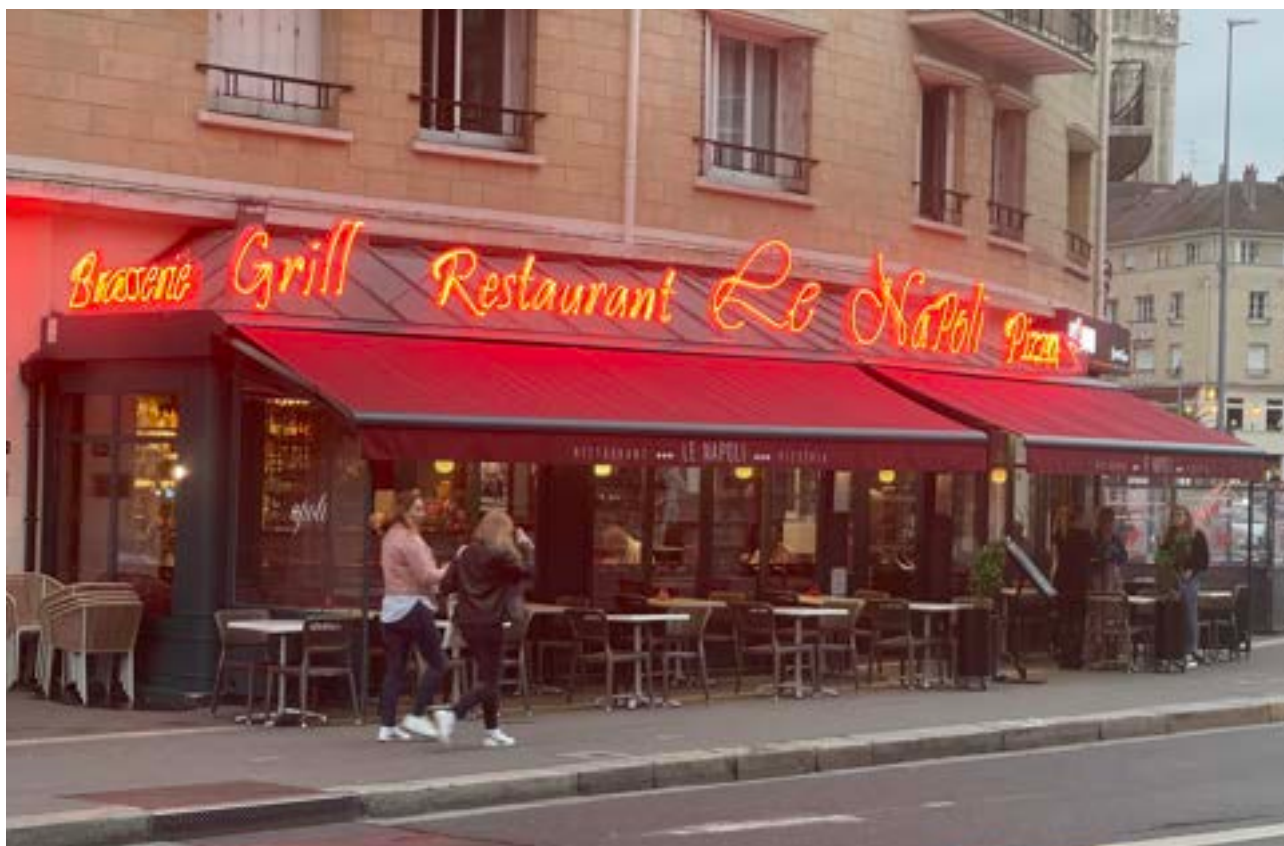
Enseigne parallèle avec des lettres découpées éclairées par des LED à Caen
