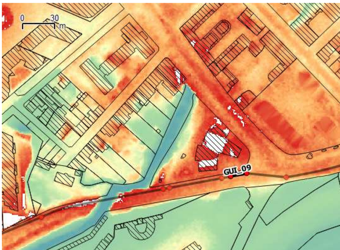
Figure 7-26 : altimétrie le long du tronçon GUI_09 (en blanc ; altitude dépassant le niveau de protection).
