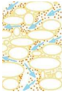
Figure 6-8 : Illustration de la suffusion
