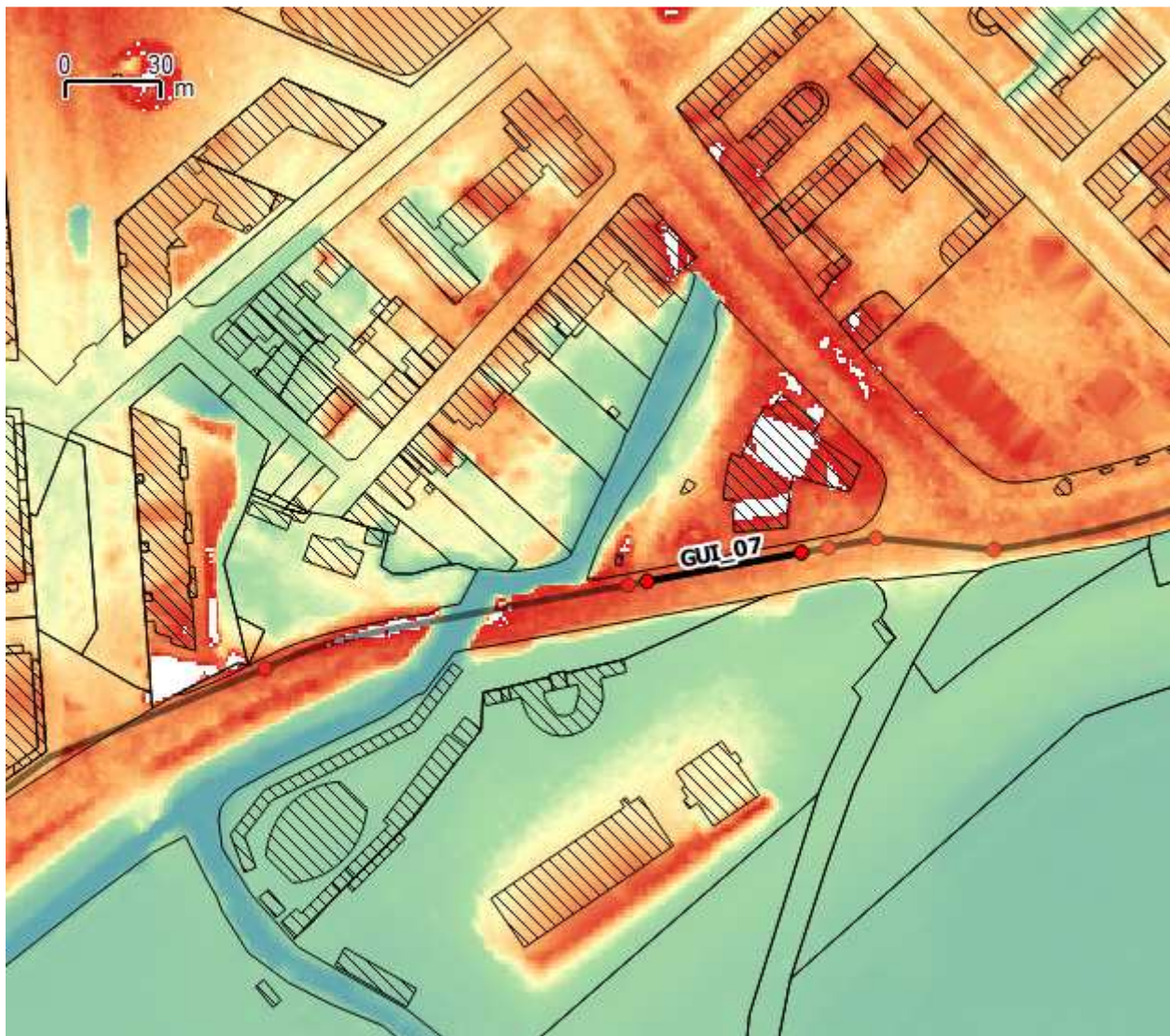
Figure 7-18 : altimétrie le long du tronçon GUI_07 (en blanc ; altitude dépassant le niveau de protection).
