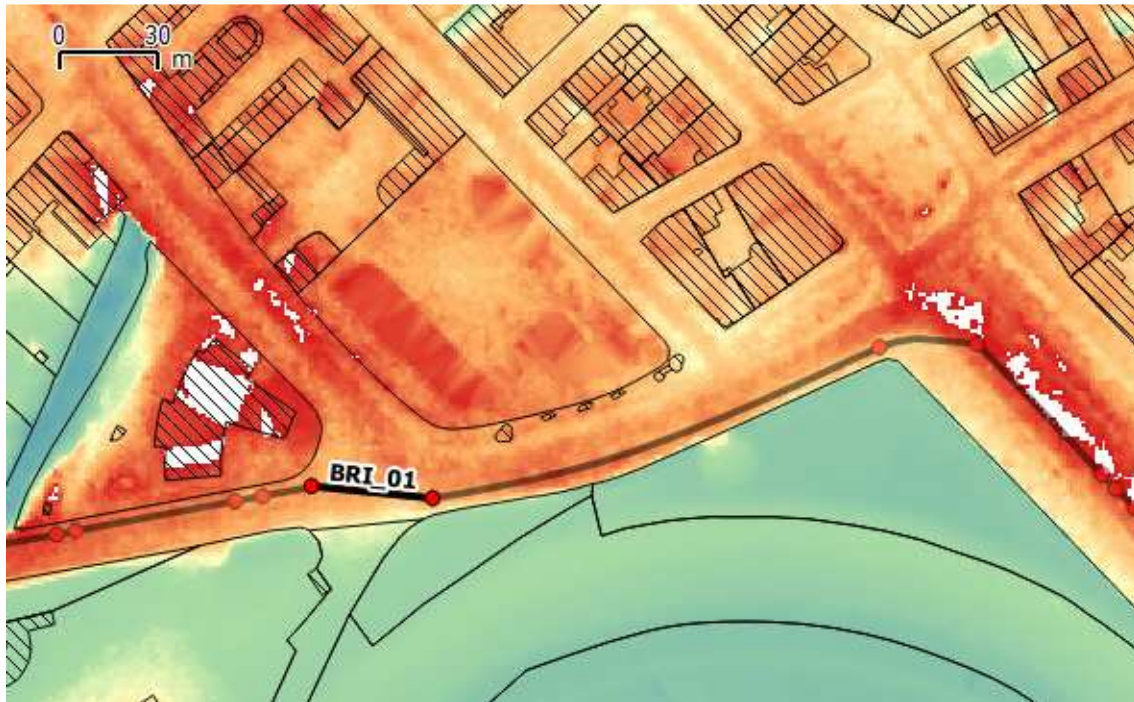
Figure 7-29 : altimétrie le long du tronçon BRI_01 (en blanc ; altitude dépassant le niveau de protection).
