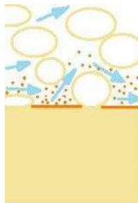
Figure 6-11 : Illustration de l'érosion de contact
