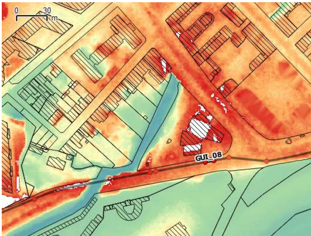
Figure 7-22 : altimétrie le long du tronçon GUI_08 (en blanc ; altitude dépassant le niveau de protection).
