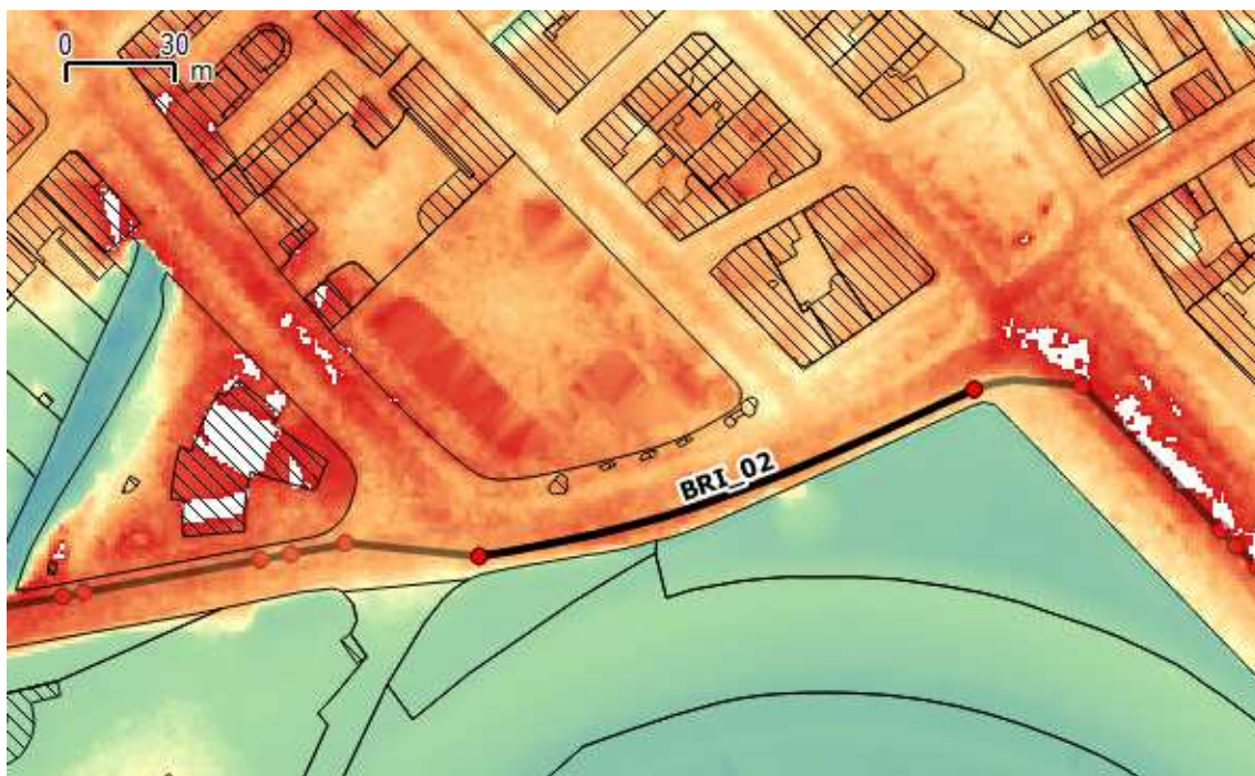
Figure 7-34 : altimétrie le long du tronçon BRI_02 (en blanc ; altitude dépassant le niveau de protection).
