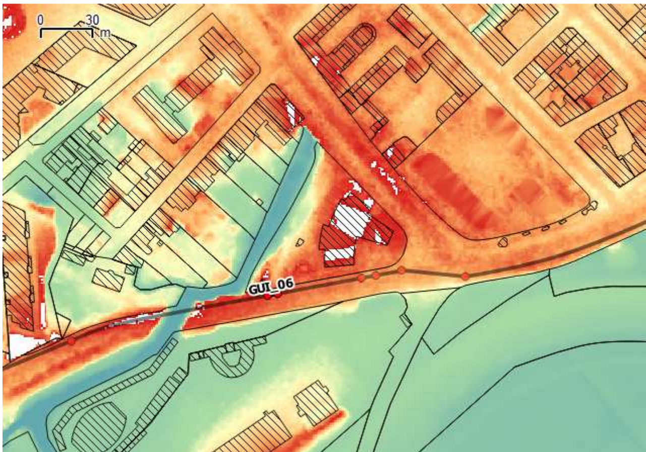
Figure 7-14 : altimétrie le long du tronçon GUI_06 (en blanc ; altitude dépassant le niveau de protection).
