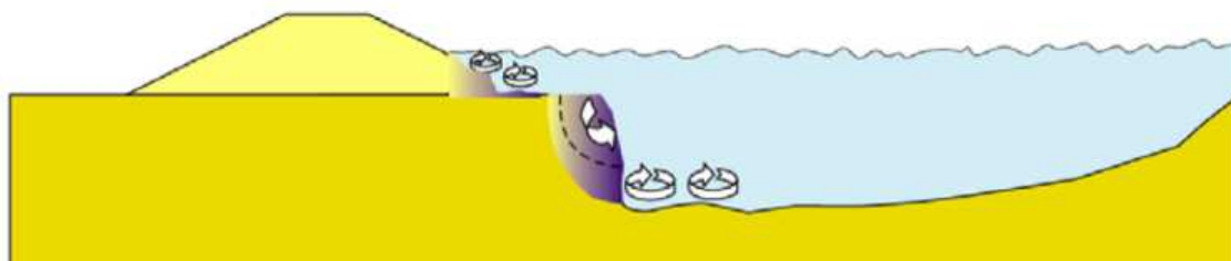
Figure 6-5 : Mécanisme de rupture par érosion externe.
