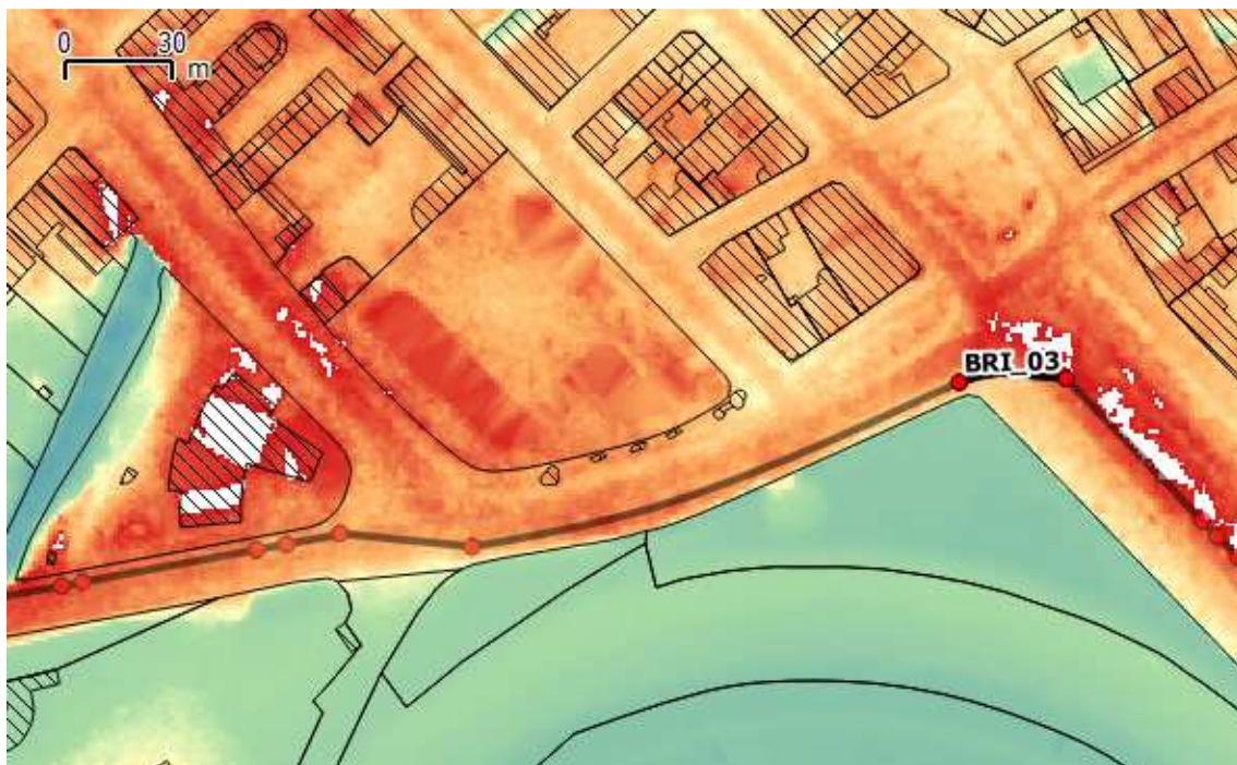
Figure 7-36 : altimétrie le long du tronçon BRI_03 (en blanc ; altitude dépassant le niveau de protection).
