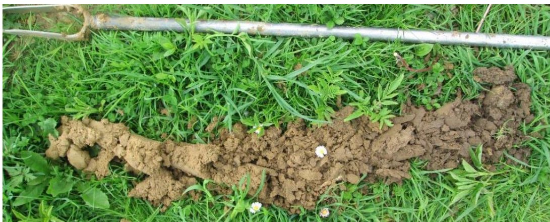
Sondage S5 : Sol Limoneux, un peu argileux, profond, pâteux en profondeur
