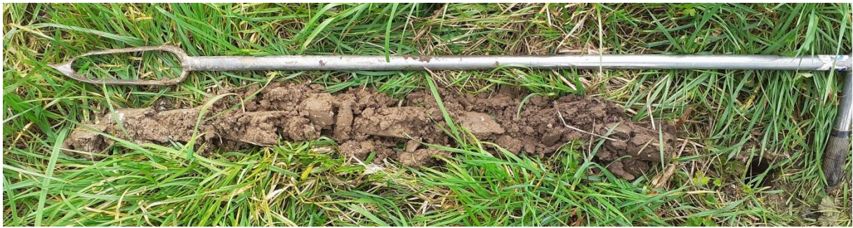
Sondage S1 : Limon devenant un peu argileux en profondeur, sain (absence de traces d'hydromorphie)
