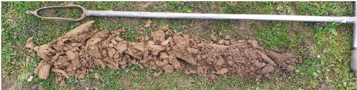
Sondage S5 : Limon devenant un peu argileux en profondeur, sain (absence de traces d'hydromorphie)
