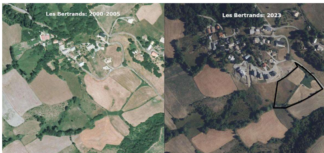
FIGURE 27: COMPARAISON DES PHOTOS AERIENNES DU HAMMEAU DES BERTRANDS (CHORGES) ENTRE 2000-2005 ET AUJOURD'HUI. LA ZONE HUMIDE CARTOGRAPHIEE EN 2022 (POLYGONE NOIR) A PROBABLEMENT VU SON PERIMETRE LARGEMENT DIMINUER A CAUSE DES REMBLAIS ET CONSTRUCTIONS EN SURPLOMB.
