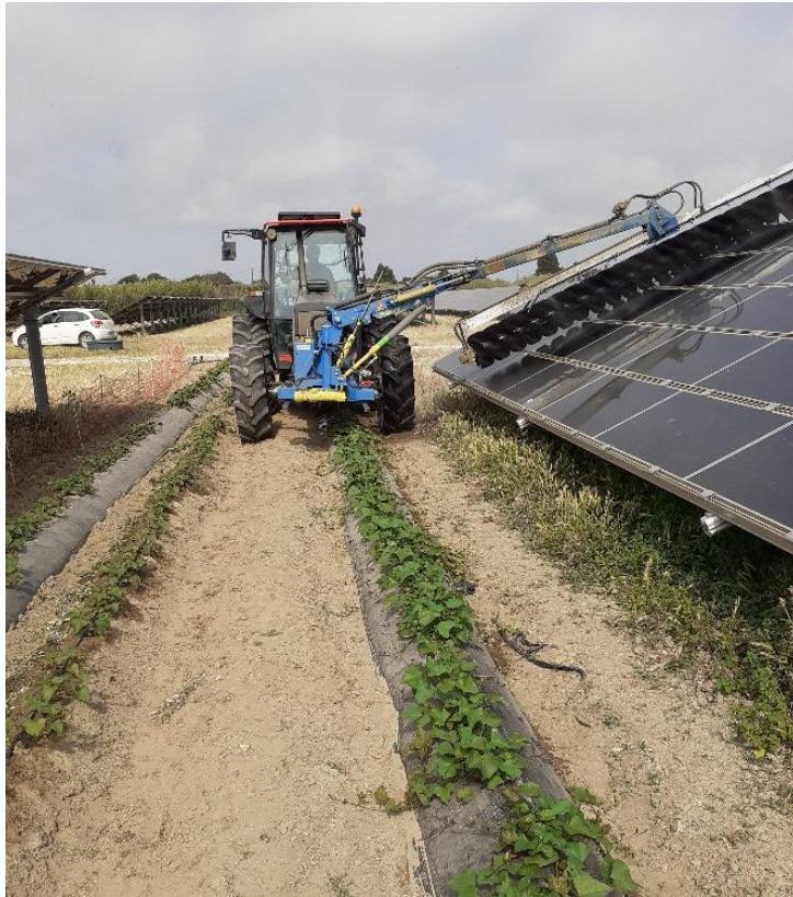
Illustration 58 : Exemple de procédé de nettoyage des modules
