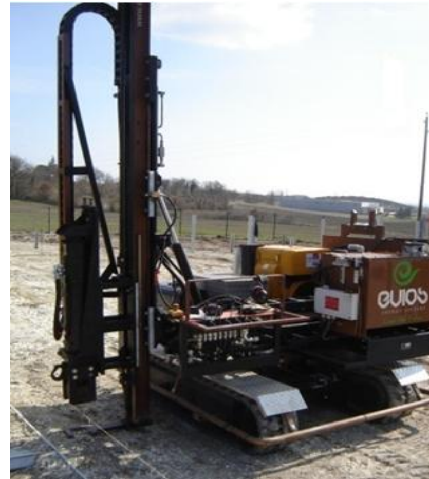
Illustration 45 : Engin de battage de pieux
