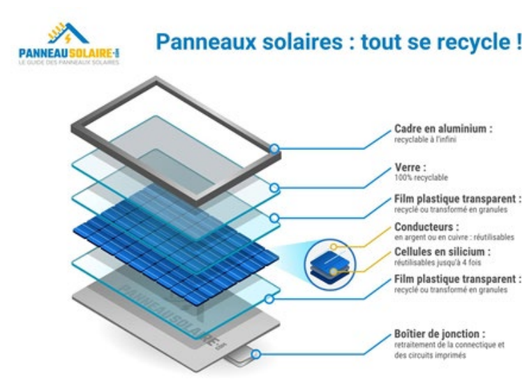
Figure 22 : Les modalités de recyclage des panneaux solaires
