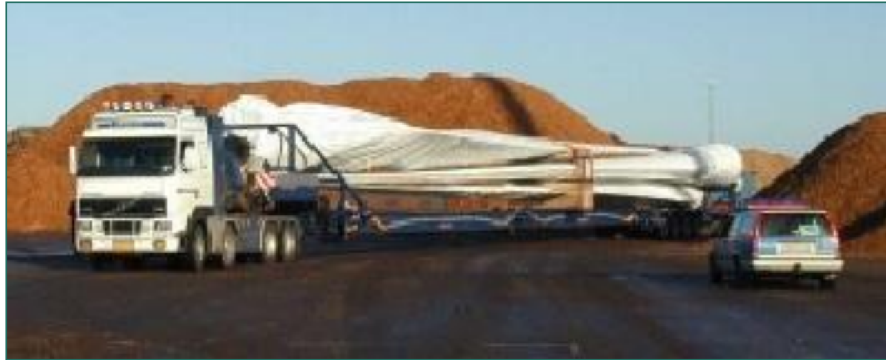
Figure 54 : Transport sur remorque des pales
