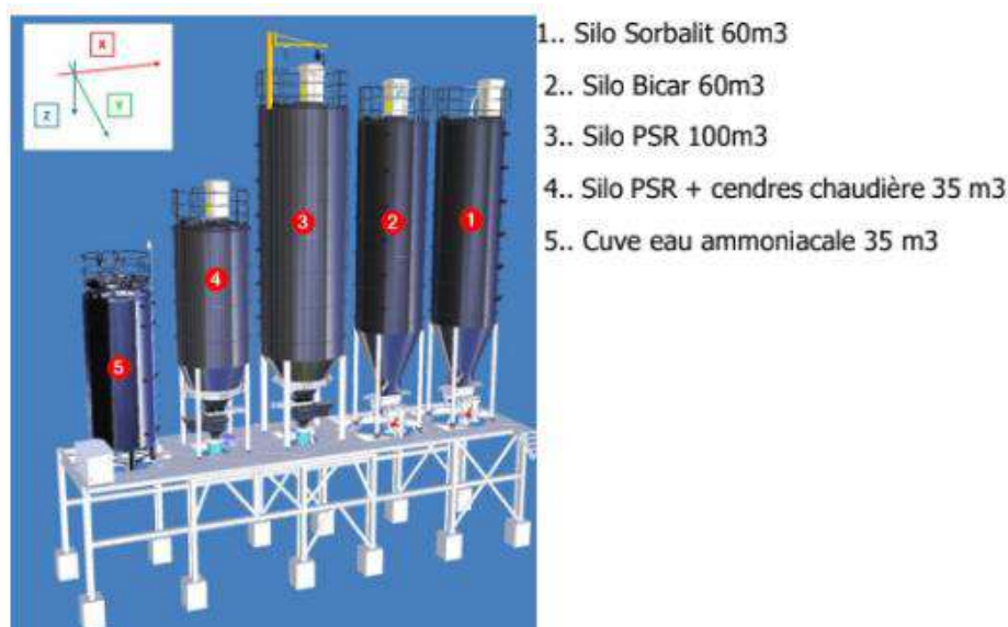
Figure 29 : Silos et cuves de stockages au-dessus de la VDI
