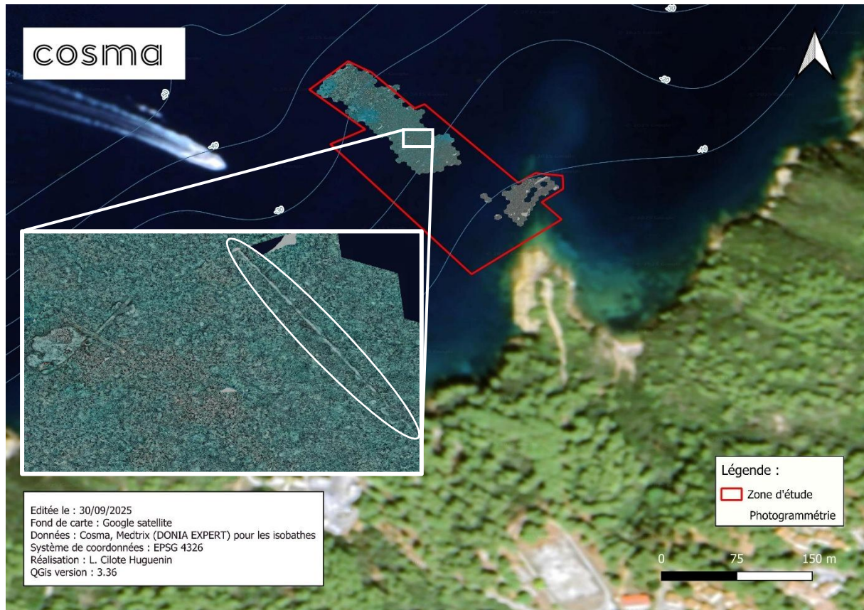
Figure 12 : Modèle photogrammétrique généré à partir des captions optiques (source : Cosma)
