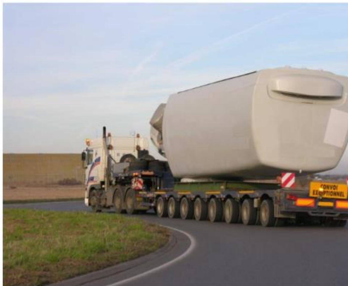
Photo 4 : Transport d'une nacelle (Source : Valorem)
