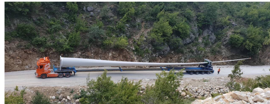
Photo 2 : Transport d'une pale (source : Faymonville 5 )
