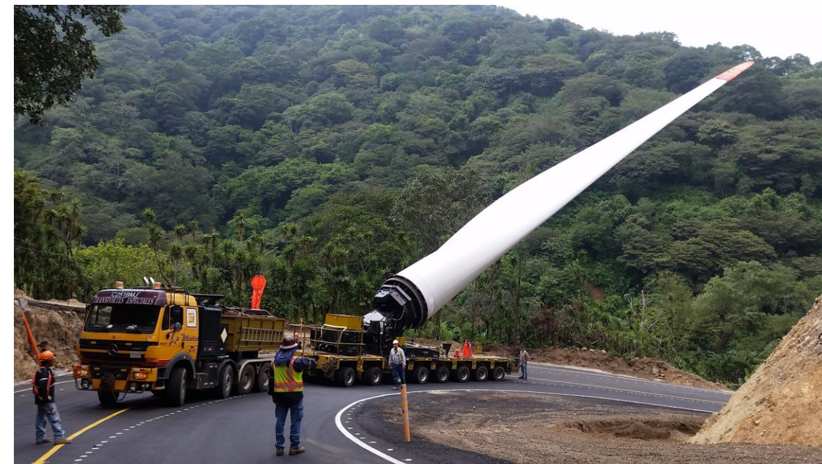
Photo 3 : Blade lifter (source : Goldhofer, Wikimedia commons)
