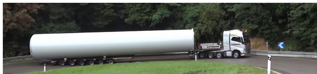
Photo 5 : Transport d'une section de mât (Source Enercon)
