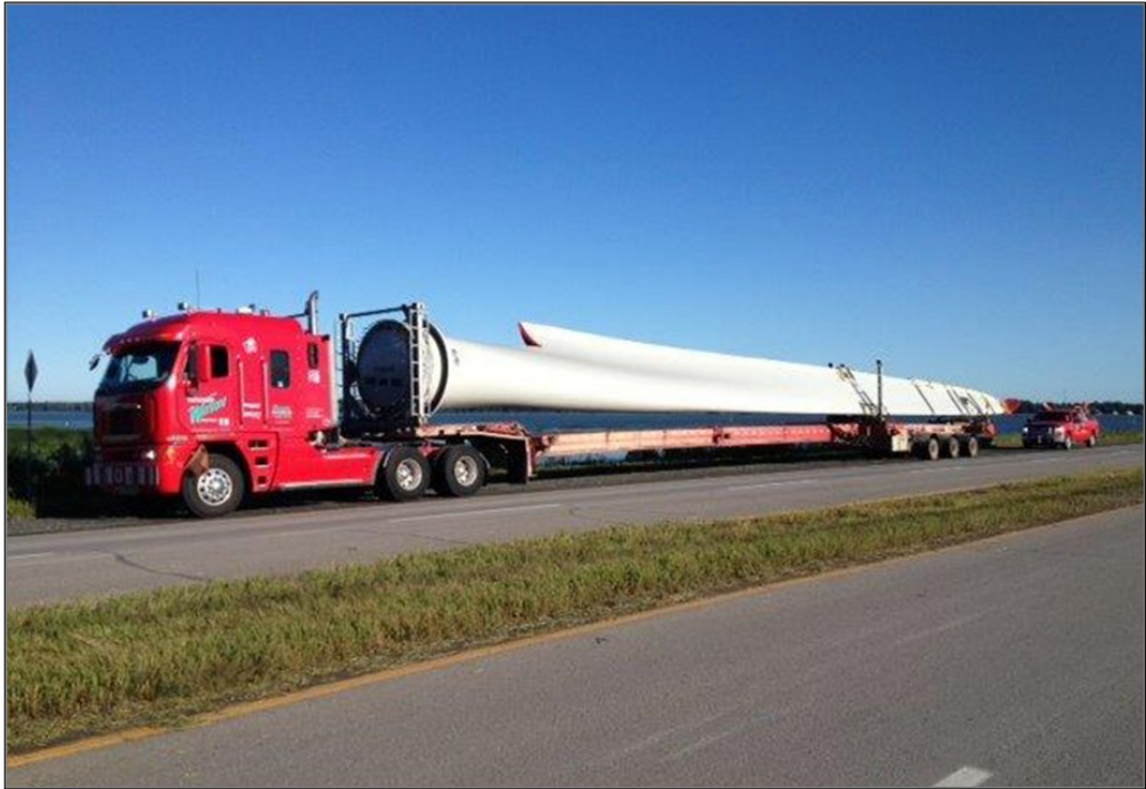
Figure 183 : exemples de transport des éoliennes en convoi exceptionnel.
