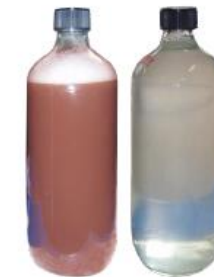
Aspect des eaux usées avant et après prétraitement
