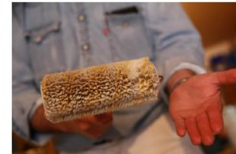
Rouleau propre après nettoyage avec la station de lavage
