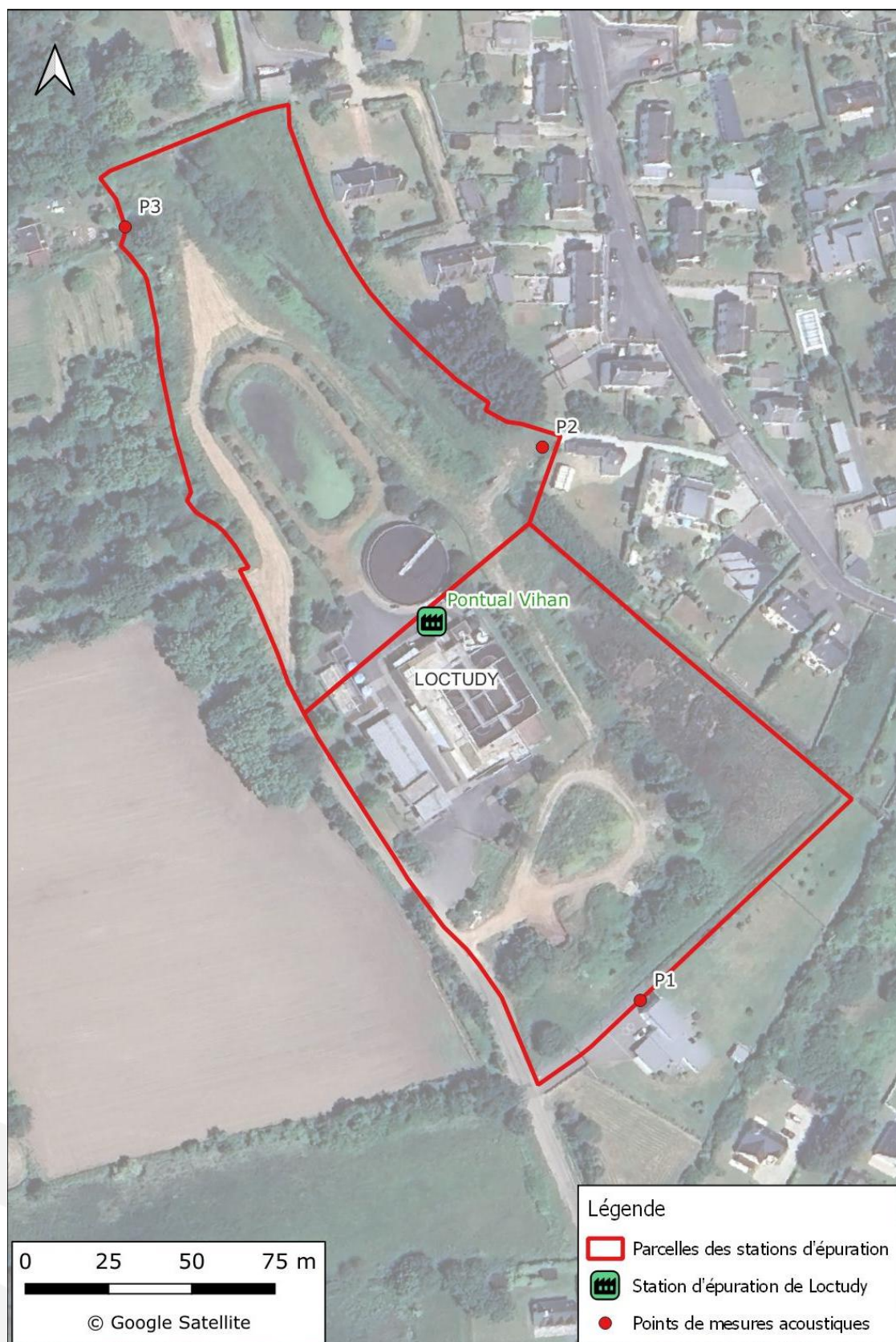
Figure 57 : Localisation des points de mesure acoustique
