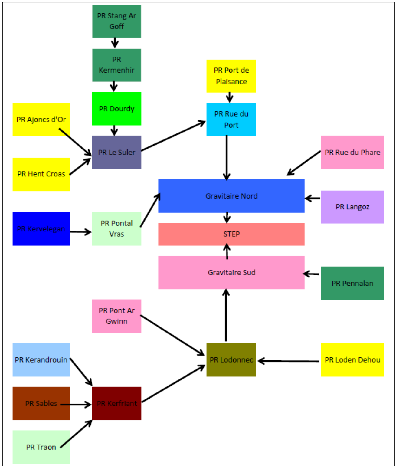
Figure 20 : Synoptique du fonctionnement du réseau de collecte de Loctudy
