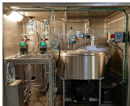
Figure 24 : Cuve d'acide formique et de peroxyde d'hydrogène (à gauche) et Unité de production (à droite)
