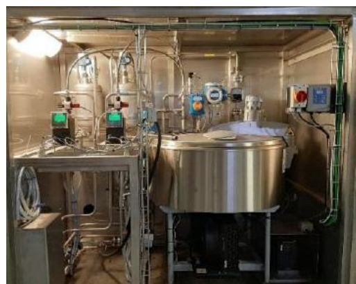
Figure 11. A gauche – Cuve d'acide formique et de peroxyde d'hydrogène – A droite – Unité de production (Source : B3E)
