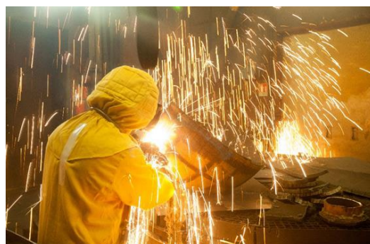
©EDF CENTRACO Cyclife - Découpe thermique avant fusion
