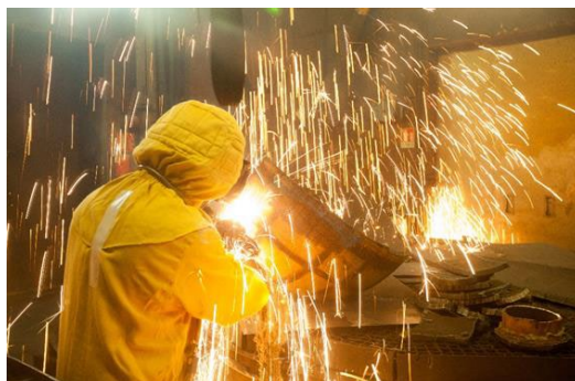
©EDF CENTRACO Cyclife - Découpe thermique avant fusion
