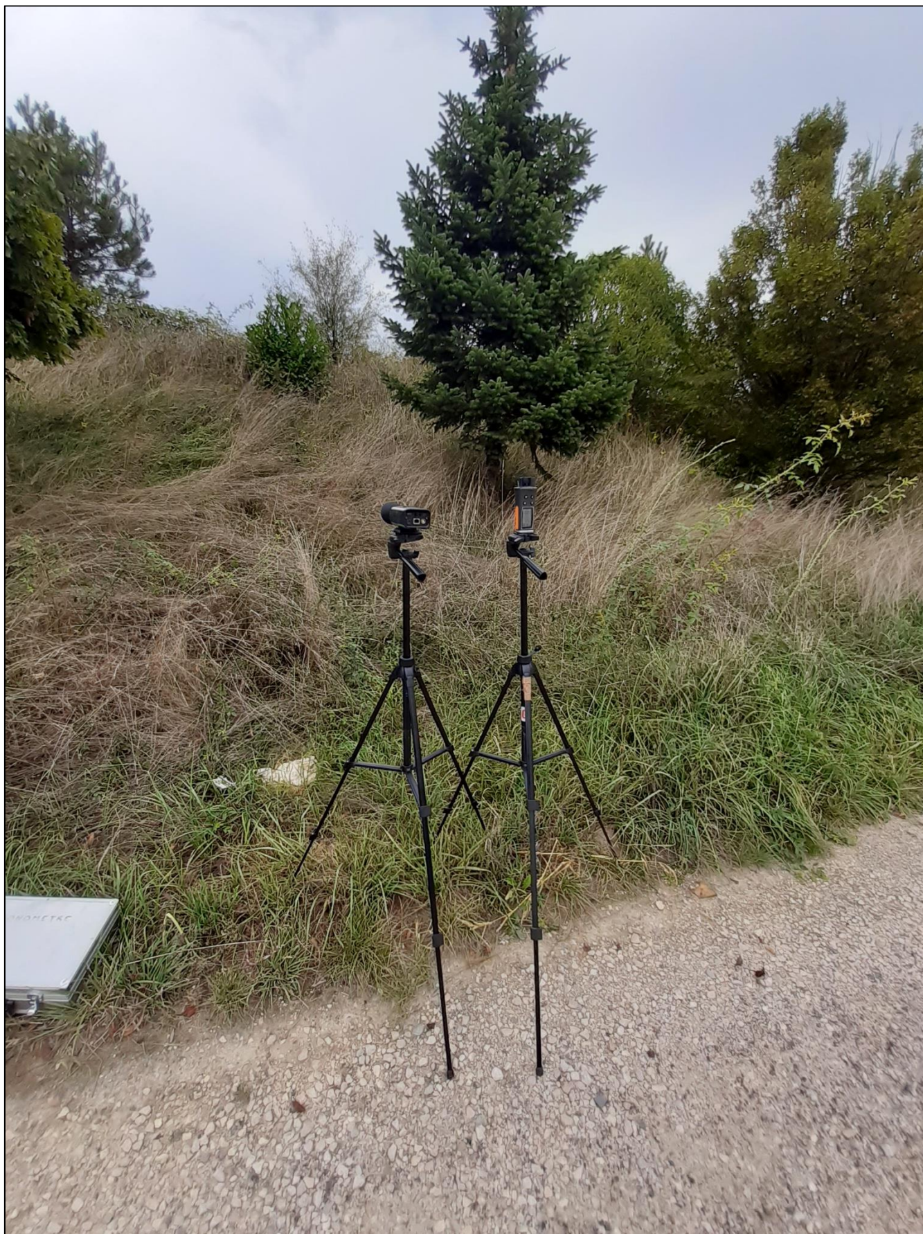
Figure 9 : Photographie du sonomètre lors de la mesure du niveau sonore en limite de site (point LIM-1 sur la Figure 1)
