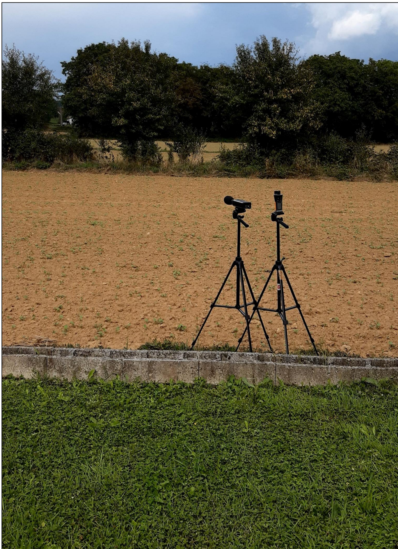
Figure 11 : Photographie du sonomètre lors des mesures des niveaux sonores en limite de Zone à Emergence Réglementée (point ZER sur la Figure 1)
