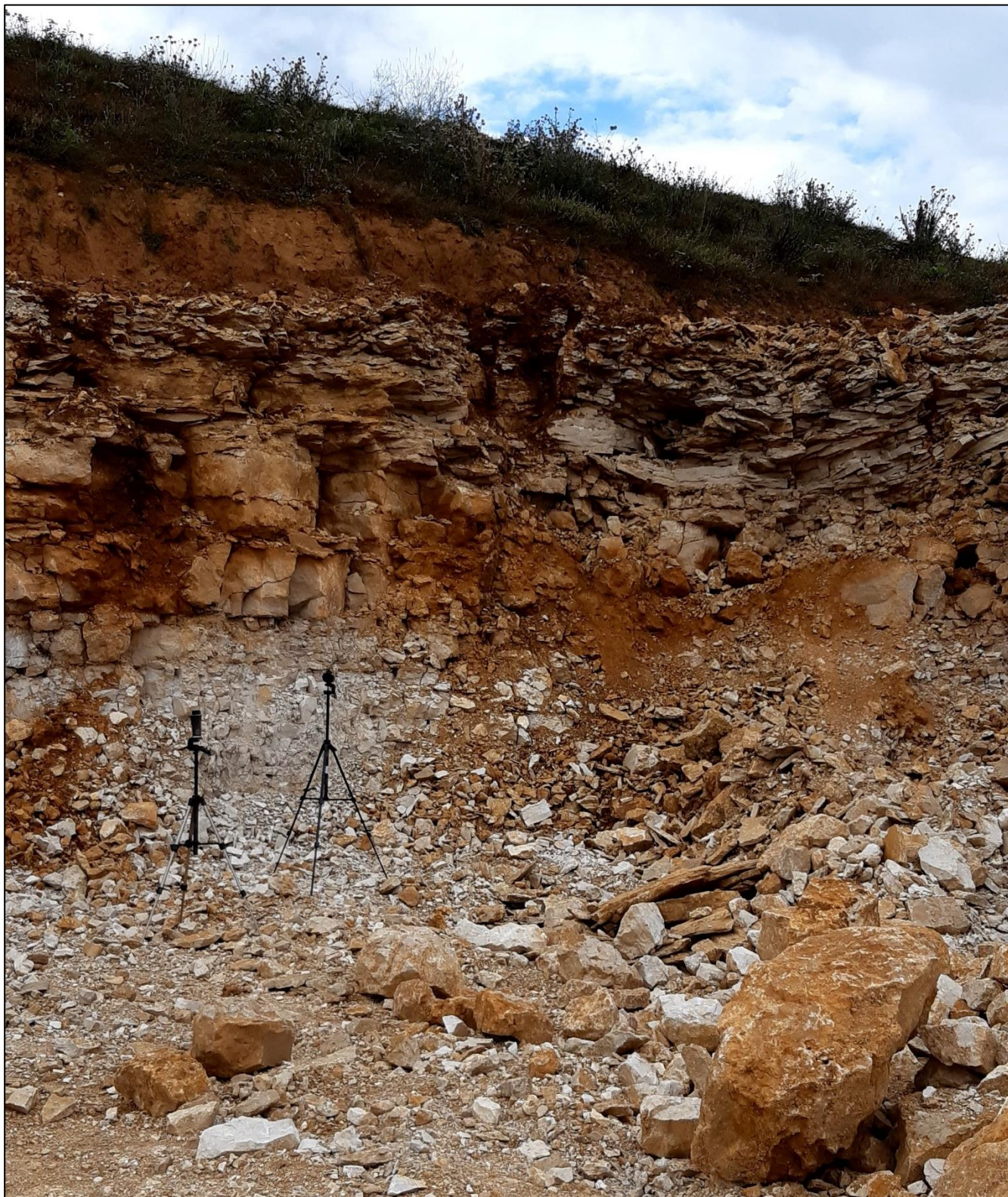
Figure 10 : Photographie du sonomètre lors de la mesure du niveau sonore en limite de site (point LIM-2 sur la Figure 1)
