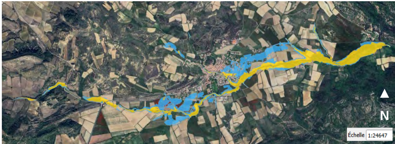
RISQUE INONDATION PAR DÉBOREMENT DU RUISSEAU DES MATTES À MONTLAUR
