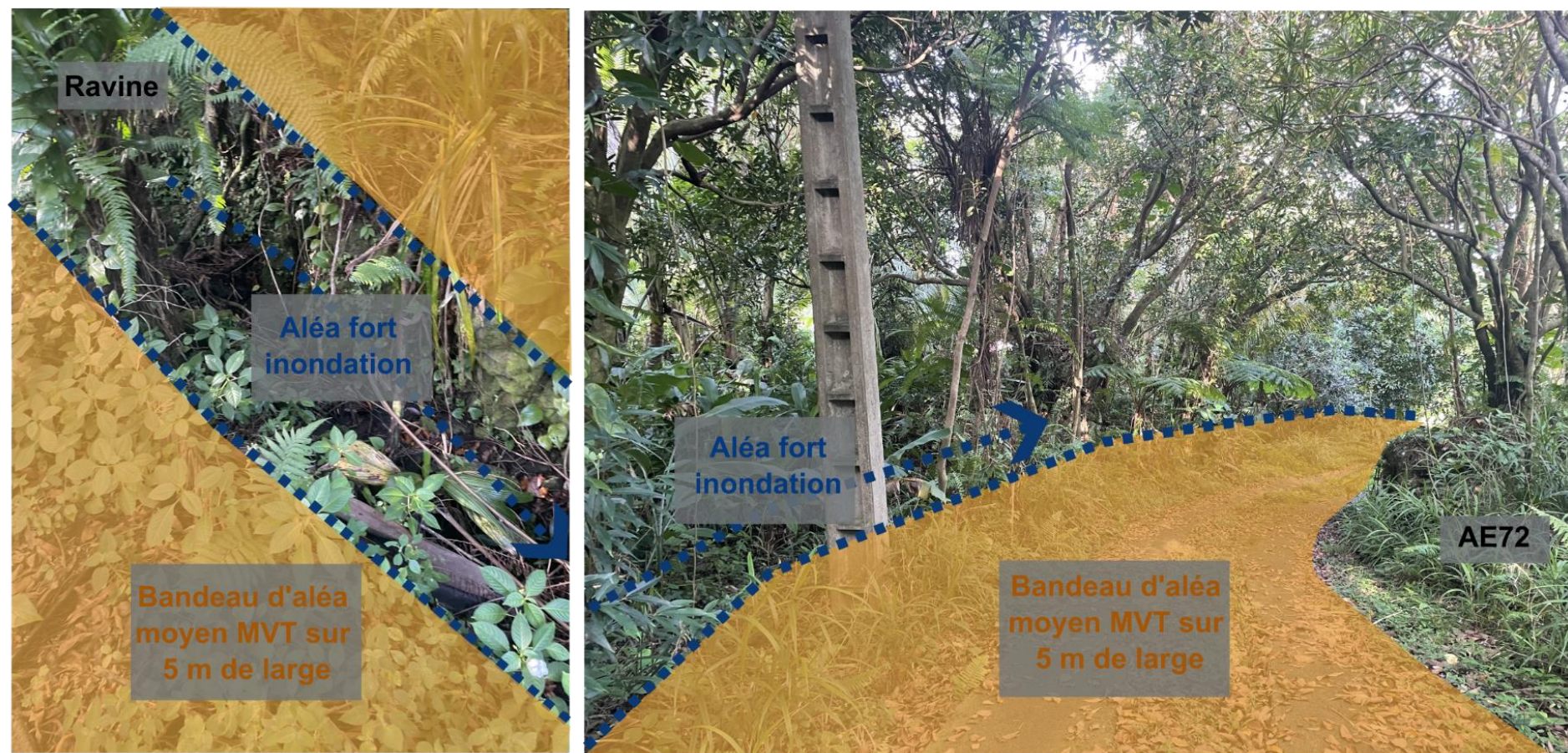
Figure 13 : Positionnement de la ravine à droite du chemin qui longe la parcelle AE72 (à gauche) et bandeau d'aléa moyen MVT de 5 m de large (à droite).
