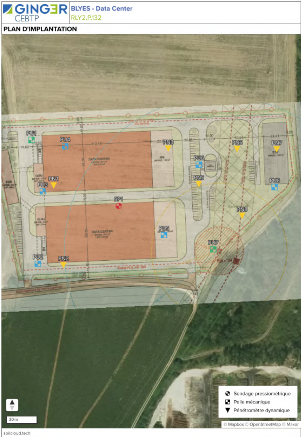
FIGURE 44 : PLAN D'IMPLANTATION DES SONDAGES GEOTECHNIQUES
