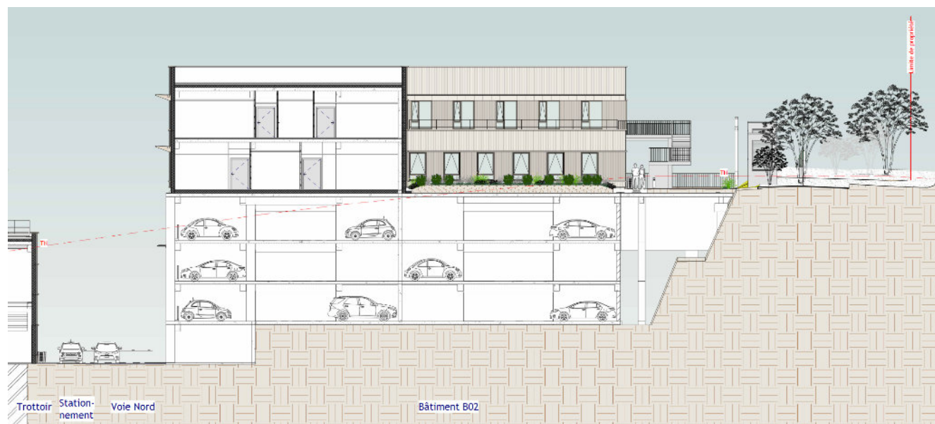
Coupe de principe du parking silo
