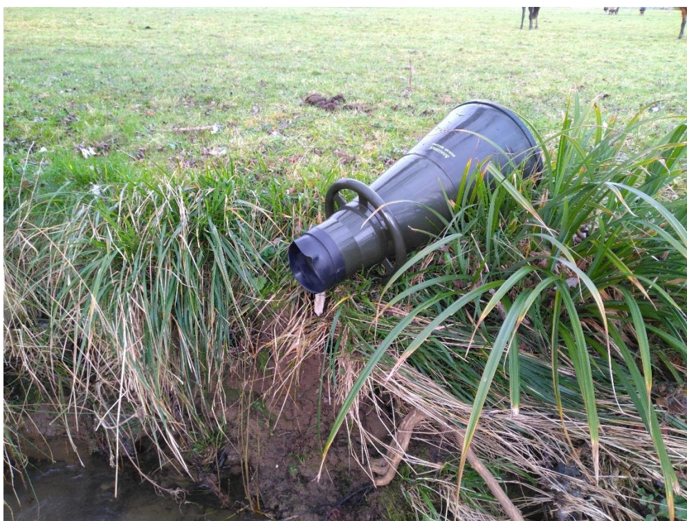
Bathyscope (ou aquascope) utilisé pour les prospections bivalves d'eau douce
