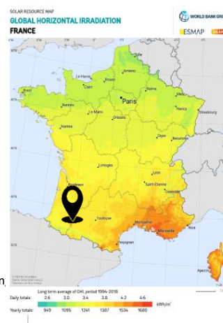
Figure 19 Description du potentiel photovoltaïque en revente
