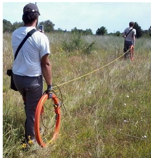
Figure 4 : Présentation du matériel conductivimètre EM34
