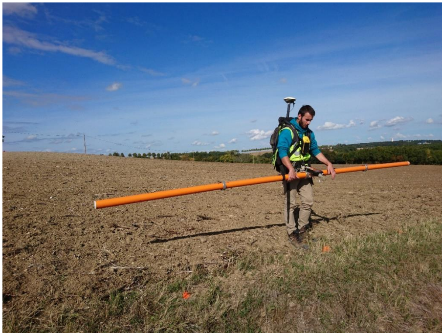
Photographie 1 : Acquisition au CMD-Explorer couplée à un DGPS
