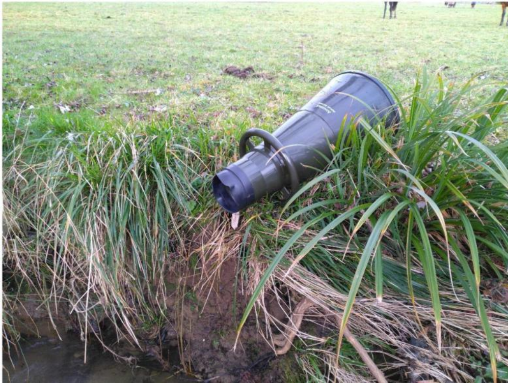
Figure 115 : Bathyscope (ou aquascope) utilisé pour les prospections bivalves d'eau douce
