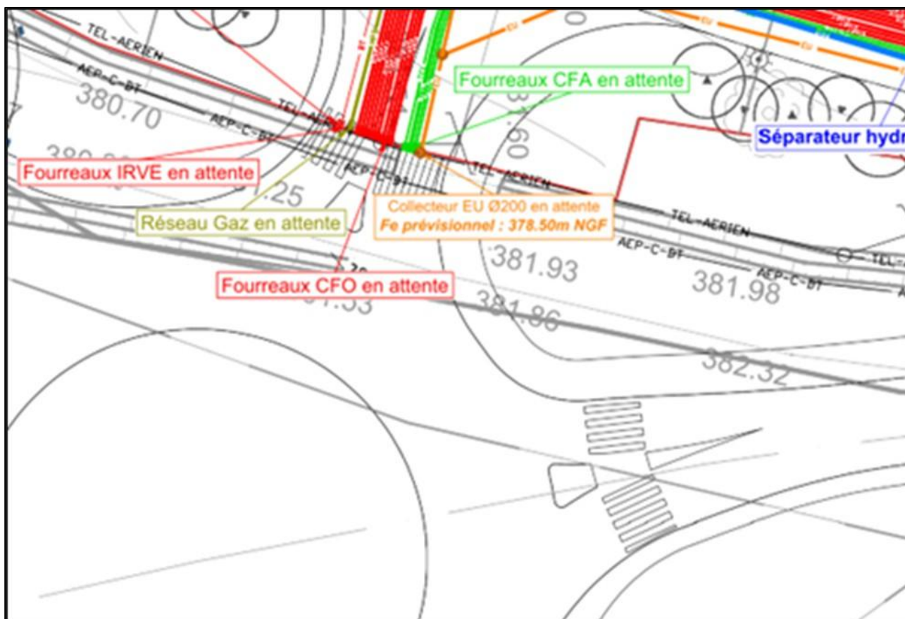
Figure 24 : Point de raccordement définitif des eaux usées de l'hôpital (Source : Compte-rendu n°45- Réunion de travail avec les concessionnaires, mai 2025)
