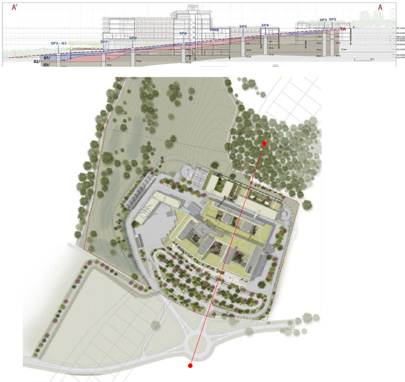
Figure 15 - Insertion des bâtiments en déblais dans le site de la colline de Croueau
