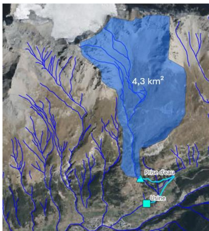
Figure 8 : Bassin versant capté à la prise d'eau
