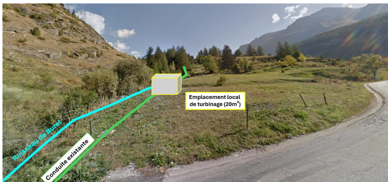
Figure 25 - vue de l'emplacement du local de turbinage sur la parcelle pâturée
