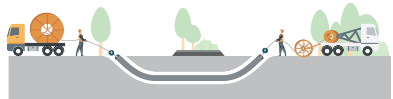
Figure 7 : Principe d'un forage dirigé Source : RTE
