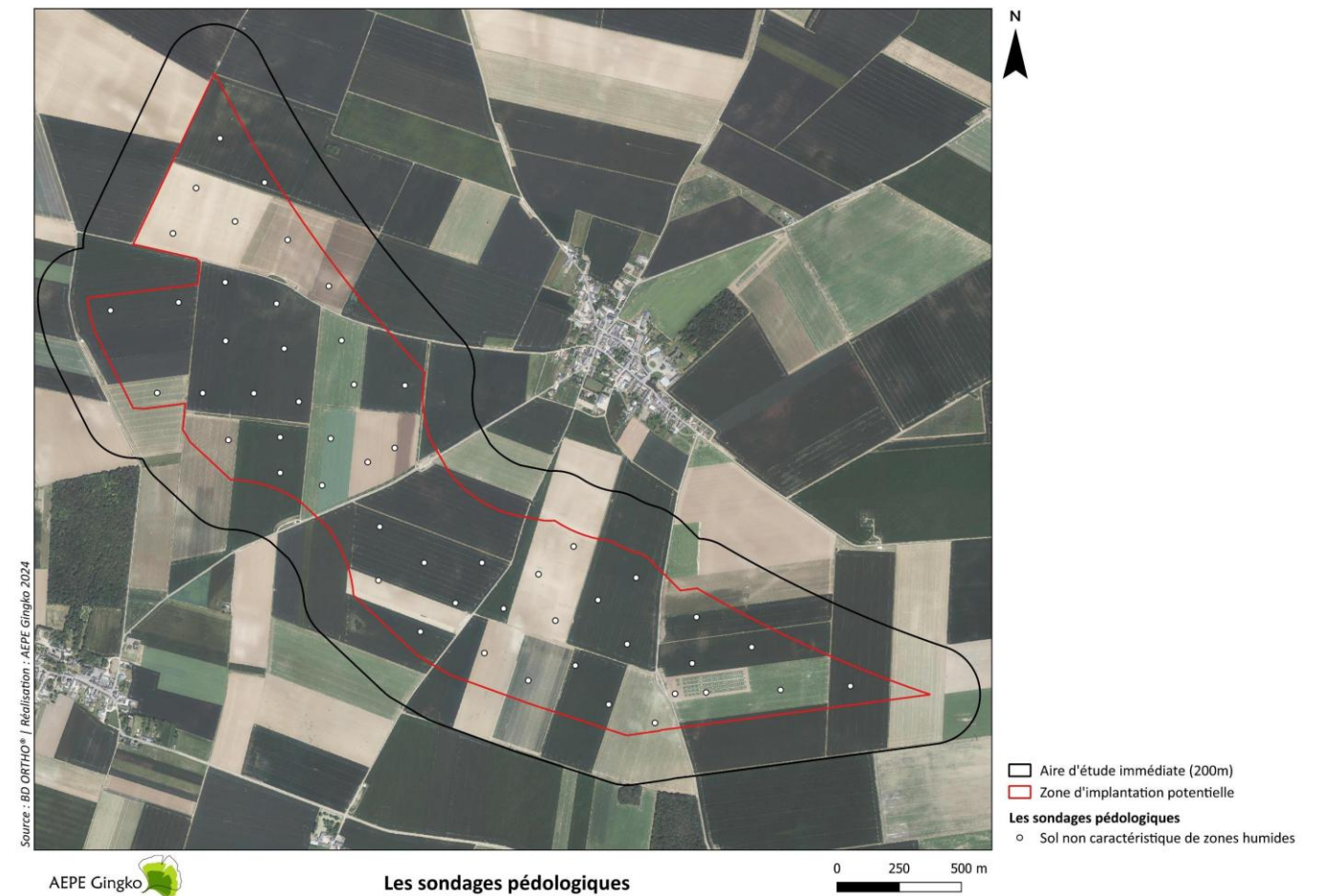
Figure 115 : Résultats des sondages pédologiques sur le site au sud Source : AEPE Gingko
