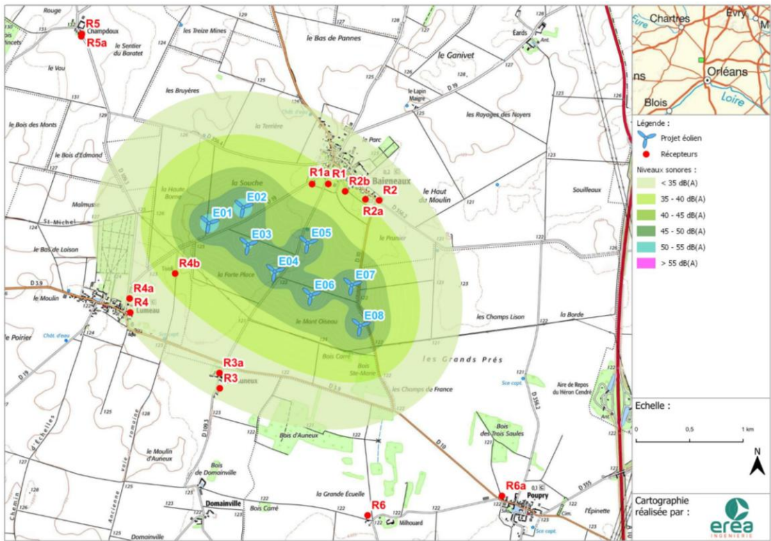
Figure 189 : Isophone à 2 m du sol de la contribution des éoliennes à une vitesse de vent standardisé de 5 m/s – Vents de Nord-Est Source : EREA Ingénierie
