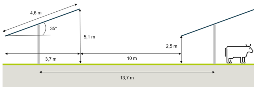
Figure 17 : Schématisation du fonctionnement des tables fixes (source : Tenergie)
