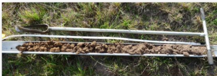
Figure 19 : Sondage pédologique à la tarière manuelle - © Écosphère
