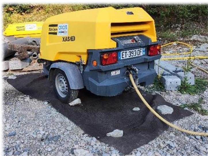
Photo 40 : Engin de chantier disposé sur un géotextile absorbant (P. SALEN, Écosphère)
