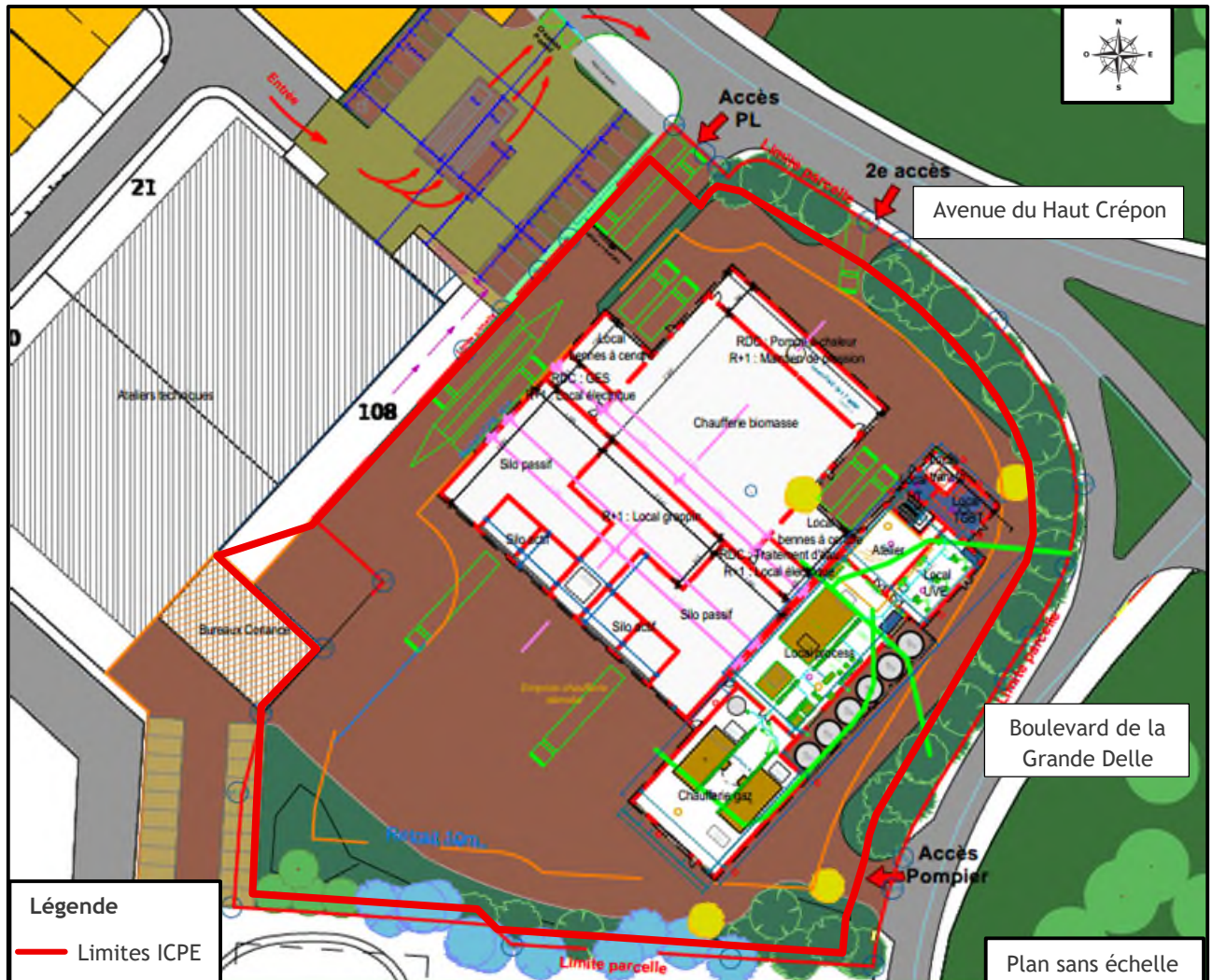
Figure 21. Localisation des accès pompiers (source : CORIANCE)
