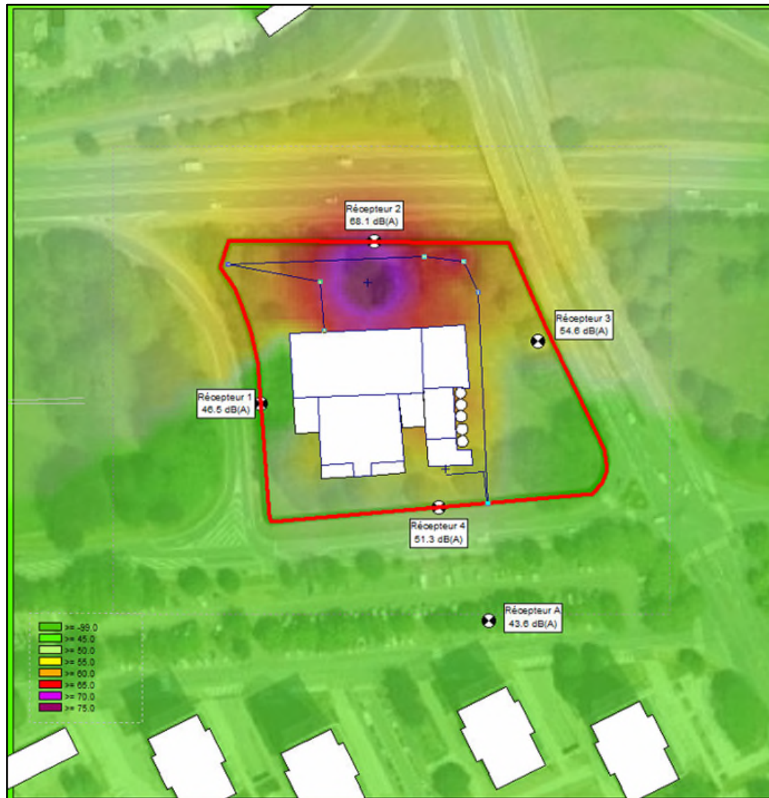
Figure 125. Cartographie du bruit en 2D - Période de jour - Site du Chemin Vert
