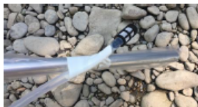
Attache du tuyau avec crépine au bout de la perche
