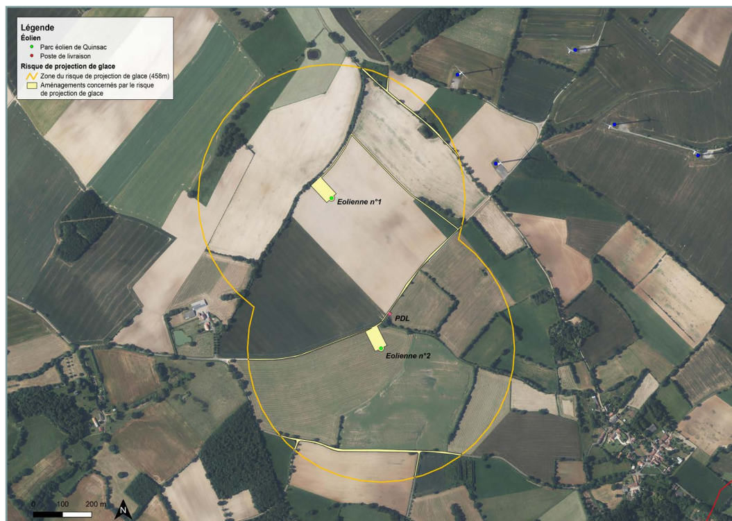
FIGURE 86: Cartographie du risque de projection de morceaux de glace
