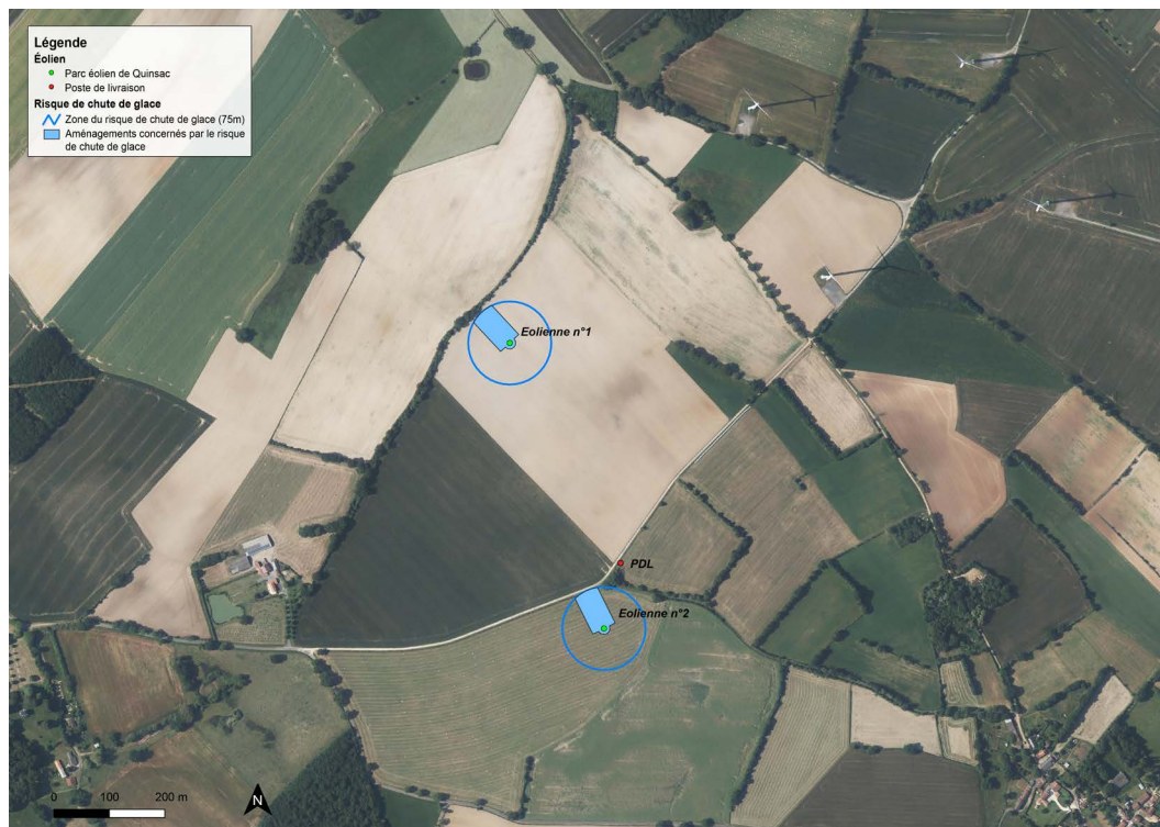
FIGURE 75: Cartographie du risque de chute de glace et d'éléments de l'éolienne
