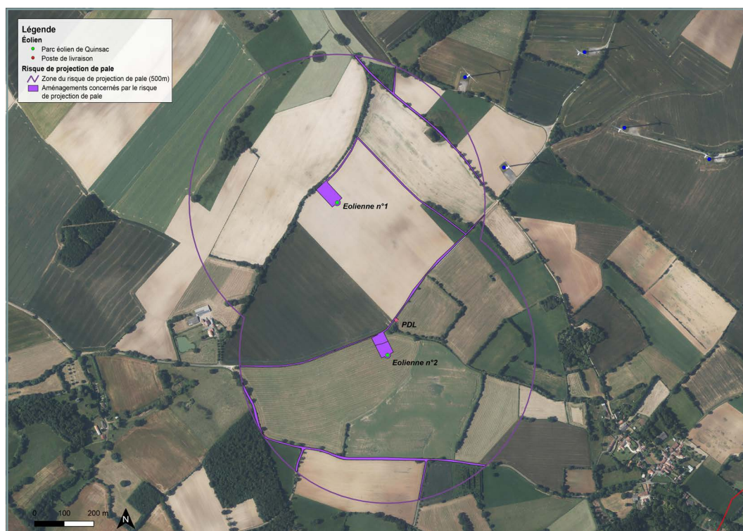
FIGURE 81: Cartographie du risque de projection de pale ou de fragment de pale
