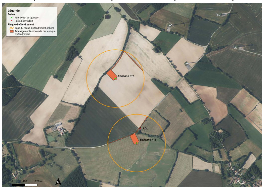
FIGURE 66: Cartographie du risque d'effondrement
