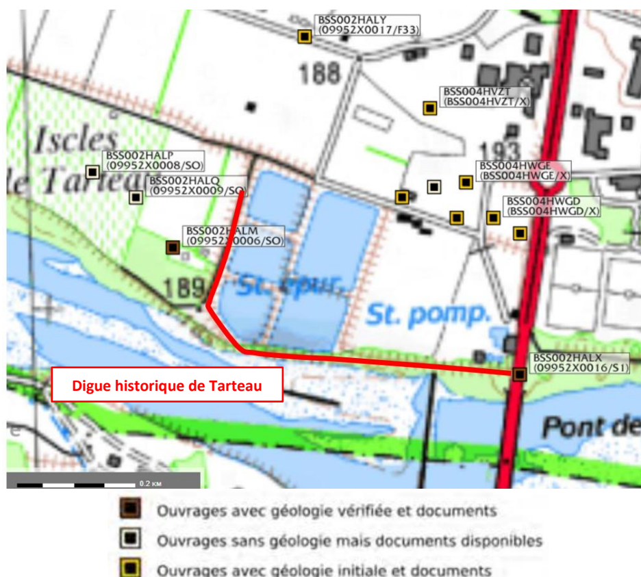
Figure 76 : Localisation des sondages de la BSS réalisé à proximité de la digue historique de Tarteau (source : GEOLITHE, 2023)
