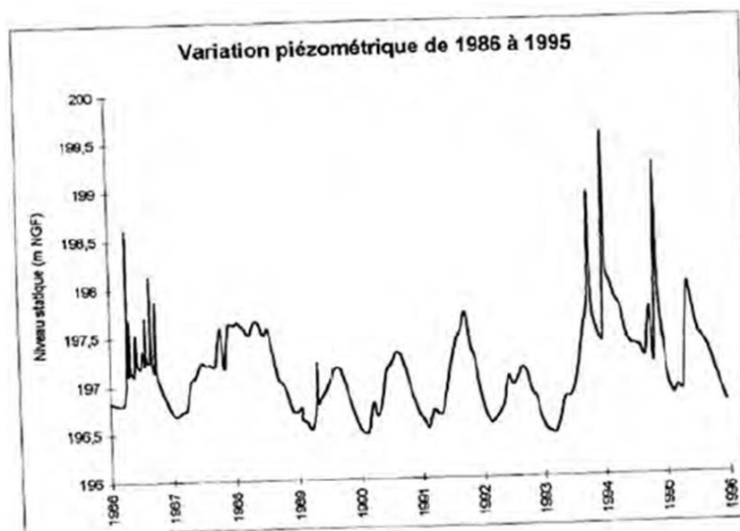
Figure 72 : Variation piézométrique entre 1986 et 1995 – Piézomètre F5b (source : BRGM)
