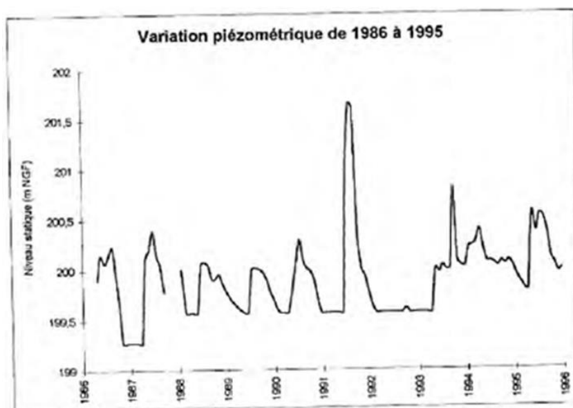
Figure 69 : Variation piézométrique entre 1986 et 1995 – Piézomètre F2 (source : BRGM)
