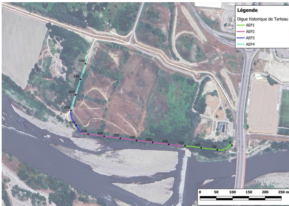
Figure 33 : Digue historique de Tarteau – Tronçons homogènes
