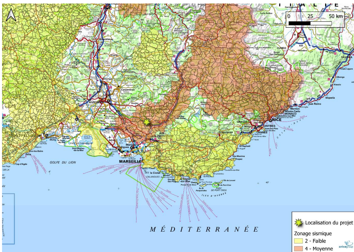
Figure 58 : Zonage sismique (source : Antea Group)
