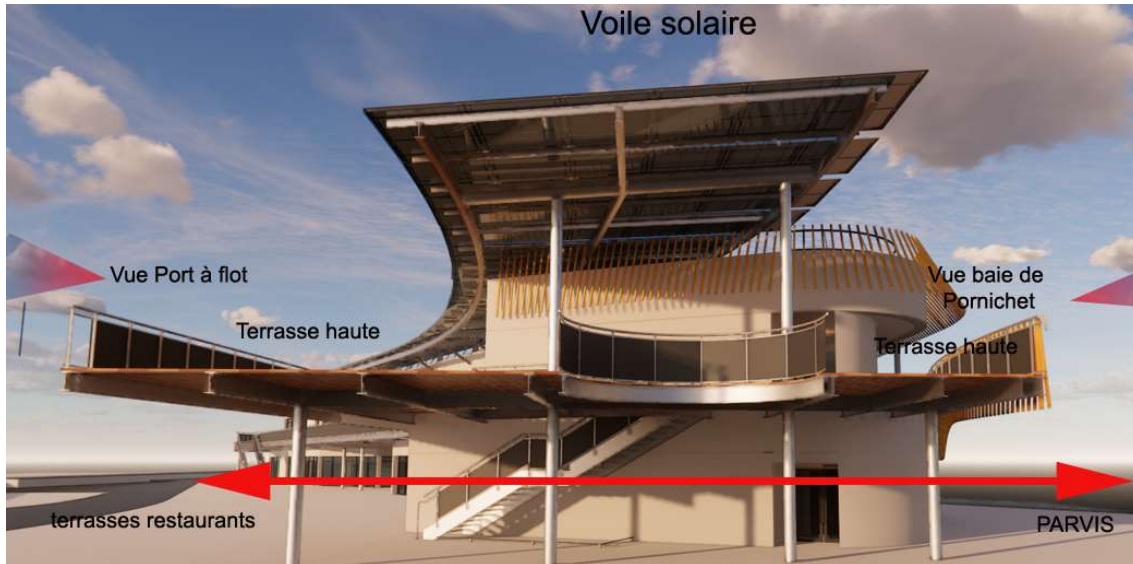
Coupe schématique sur parvis boomerang
