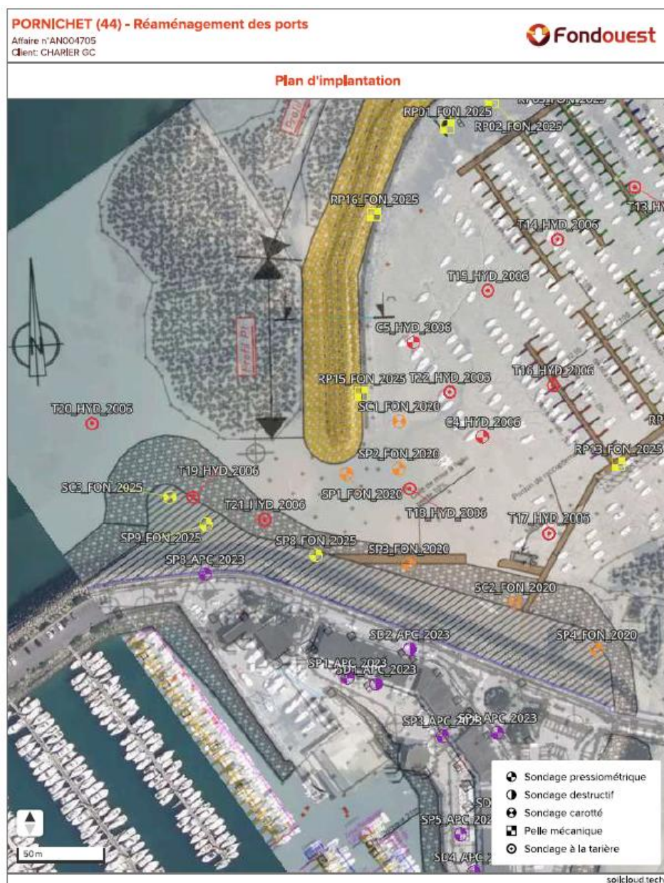
Figure 129 – Carte de localisation des sondages géotechniques sur le secteur du terre-plein (Fondouest, 2025)
