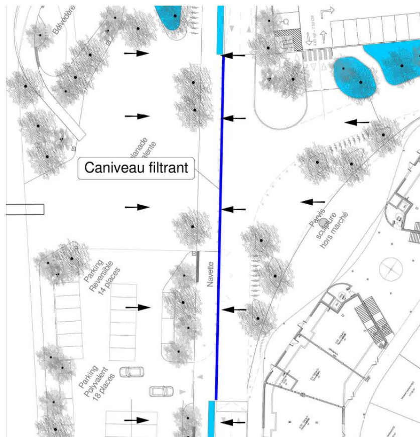
Figure 139 : Localisation du caniveau filtrant
