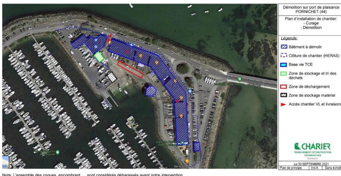
Figure 38 - Plan d'installation du chantier
