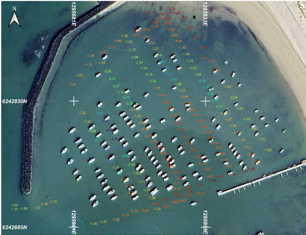
Figure 11 : Altimétrie du toit rocheux dans le port d'échouage (m CM) – Energie de la Lune 2025
