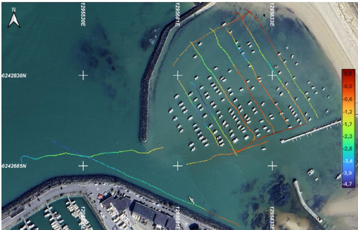
Figure 12 : Altimétrie du toit rocheux dans le port d'échouage et le chenal d'accès (m CM) – Energie de la Lune 2025
