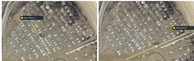
Figure 42 : Bassin d'échouage – Pentés du terrain naturel
