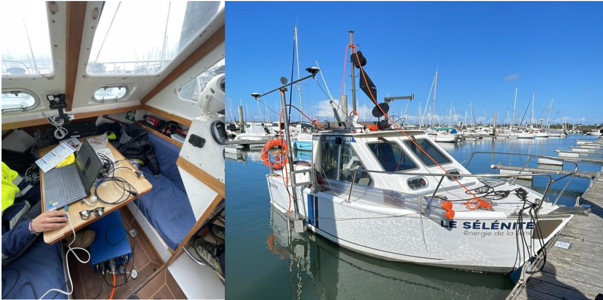
Figure 8 : Instrumentation océanographique du Sélénite avec la perche installée à tribord, l'antenne secondaire installée sur bâbord, l'écran de navigation pour le pilote et la partie inférieure de la perche posée sur le pont avec le sondeur multifaisceau et la centrale inertielle.
