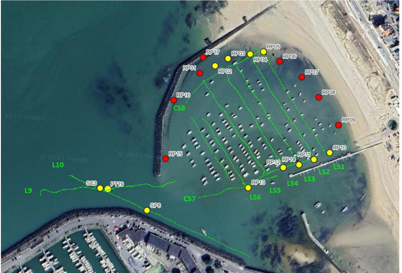
Figure 6 : Localisation des transects au sondeur de sédiments et exploités (traits verts) ainsi que la localisation des sondages de 2025 (points jaunes) utilisés pour valider notre expertise (point rouge, sondages non utilisés).
