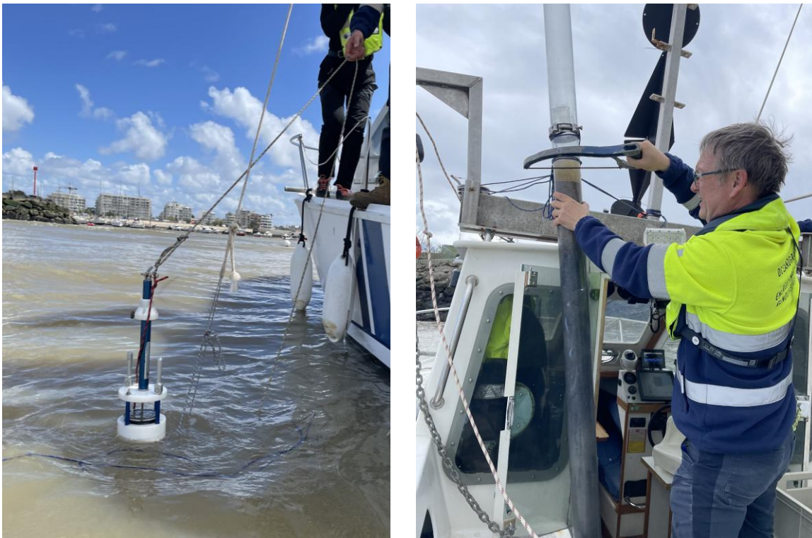
Figure 9 : Carottage au PT19 (1,65m) – Chenal d'accès du Port d'Echouage de Pornichet.
