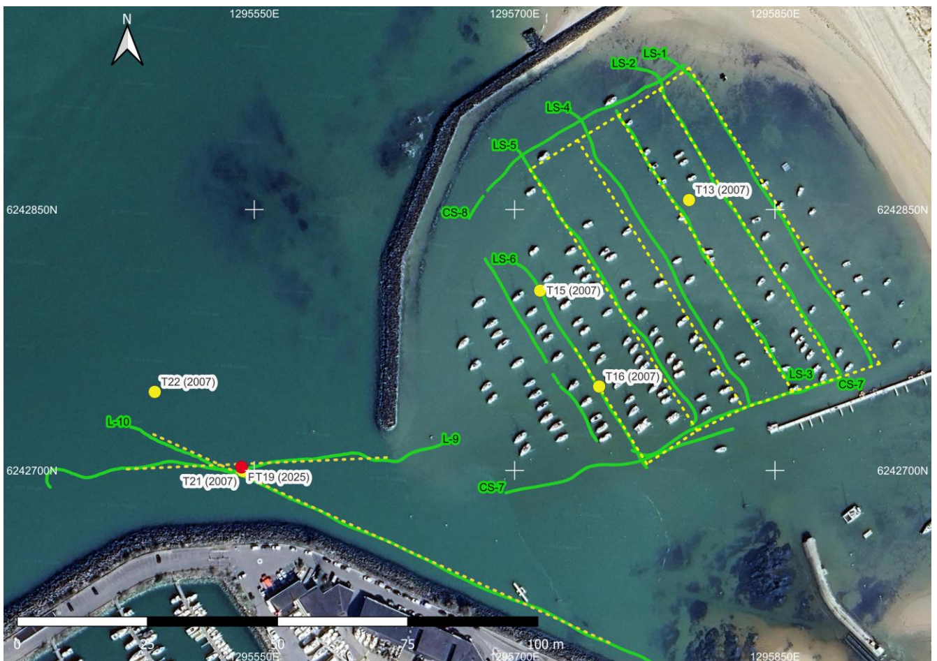
Figure 5 : Localisation des transects de projet (pointillés jaunes) et réalisés au sondeur de sédiments exploités (traits verts) ainsi que la localisation des sondages de 2007 (points jaunes) utilisés pour valider notre expertise ainsi que la carotte PT19 réalisée en avril 2025 (point rouge).
