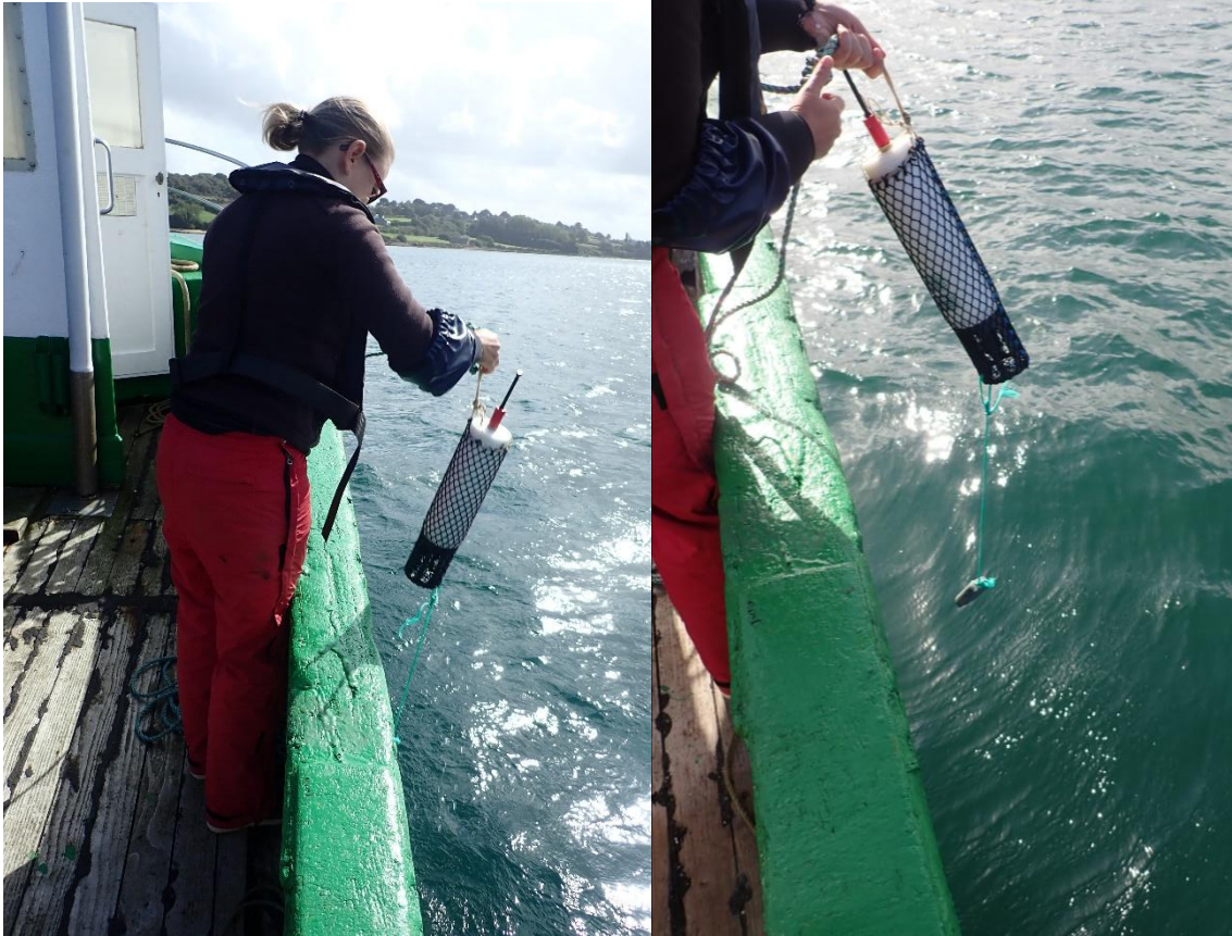
Figure 4. Sonde MP4 CTDDO (NKE) utilisée pour mesurer les paramètres physico-chimiques.
