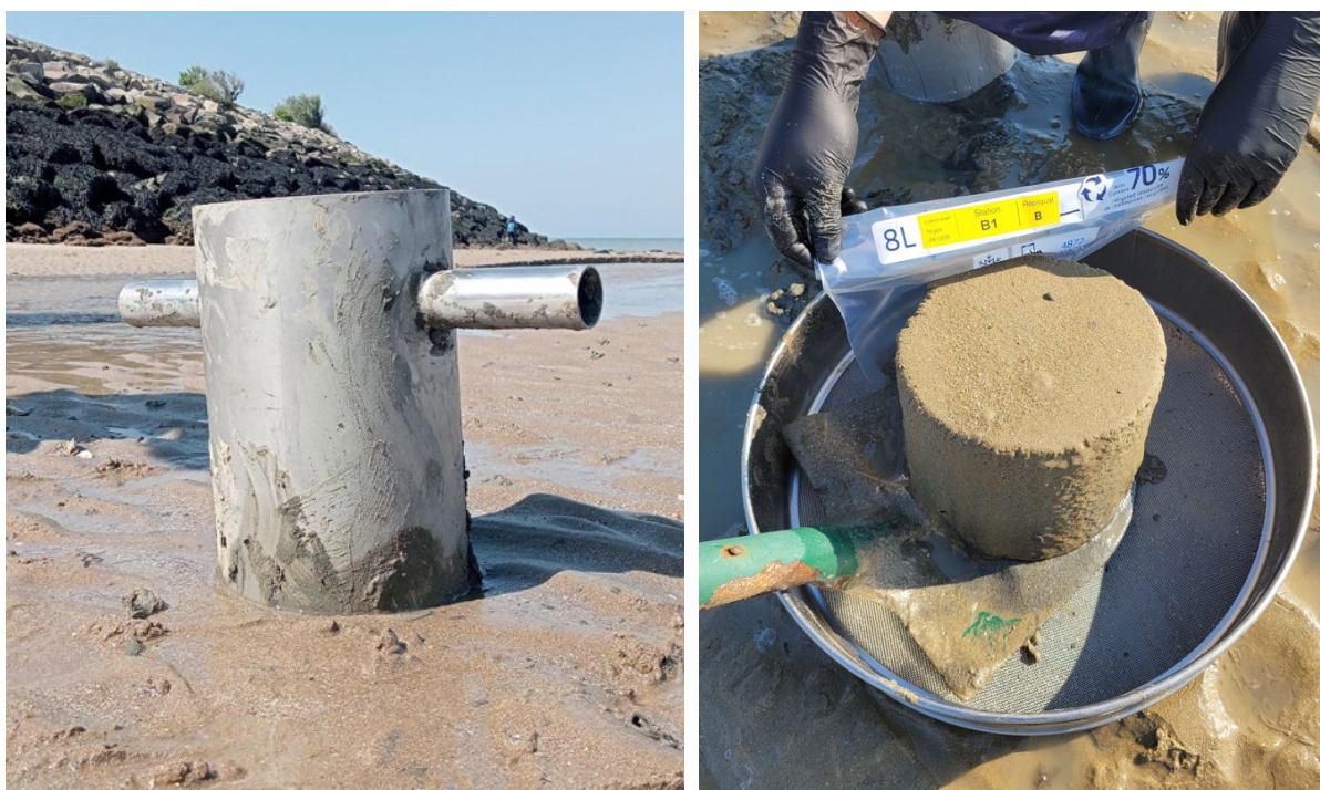
Figure 2-3 : Carottier utilisé et prélèvement réalisé annoté
