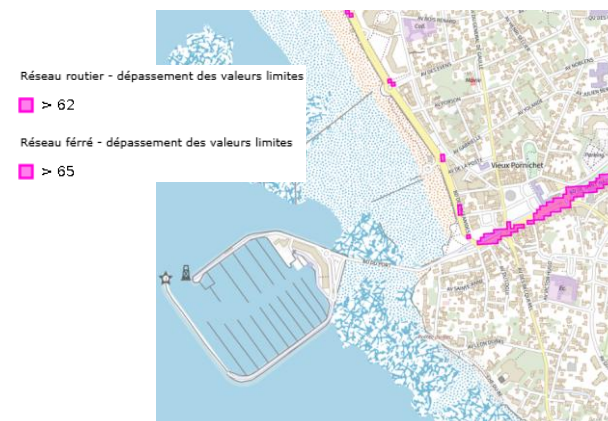
Figure 5 – Carte de type « C » - zones de dépassement la nuit (Ln) au bruit routier
