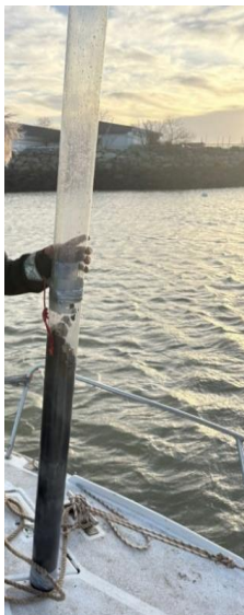
Présence d'une fissure à l'extrémité de la carotte sûrement liée à l'atteinte du toit rocheux
