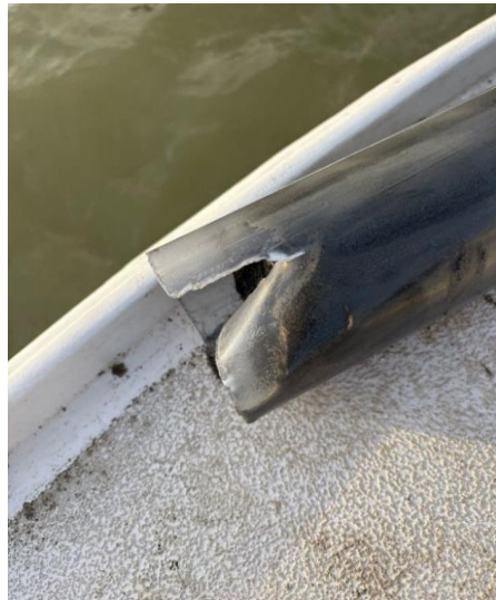
Présence d'une fissure à l'extrémité de la carotte sûrement liée à l'atteinte du toit rocheux
